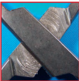
潤滑剤の不十分な使用による 腐食
