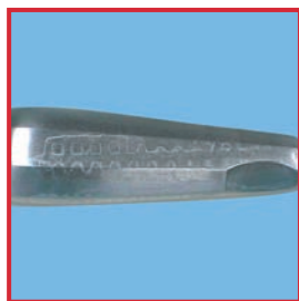
すすぎが不十分のために生じた洗浄剤残留物
