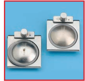
右側：新しいフラップ弁 左側：オイル等との接触によりパッキンが膨潤し、しっかり固定されなくなったトロッカーのフラップ弁
