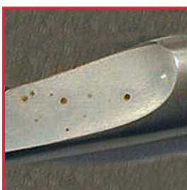
塩化物により器械に生じた孔食
