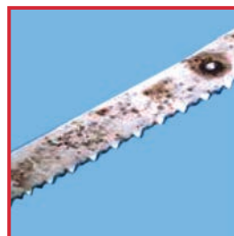
部分的に錆びたクロムメッキ炭 素鋼製鋸刃 原因：クロムメッキ層の湿度に よる剥れ（ステンレス鋼ではな い）
