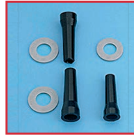
右側：新しいパッキン 左側：オイルを誤って使用したことにより膨潤したパッキン
