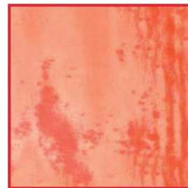
コンテナの変色した陽極酸化 アルミの表面 原因：許容されたレベルを超 えたアルカリ性洗浄剤の使用
