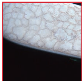
蒸気濃縮物中に含まれる二酸化珪素によって 引き起こされたしみ
