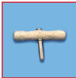
ハンダ付け表面のエッチング効果。超硬金属ハサミ、ピンセットや針ホルダー 原因：中和剤の過剰投入または酸性洗浄剤の使用による酸の影響
