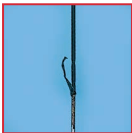
高周波手術器械の破損した絶縁体
