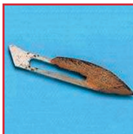
湿度により錆びた刃の表面 原因：ディスポーザブル製品で ステンレス鋼ではない
