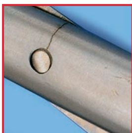
はさみヒンジ近傍の毛髪状のひび
