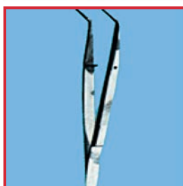
器械の表面のエッチング剤の部分的な効果と付着物。原因：接触時間が長かった。
