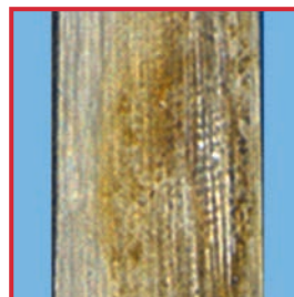
骨パンチ、スライド部分の摩擦面に摩擦による腐食が生じる
