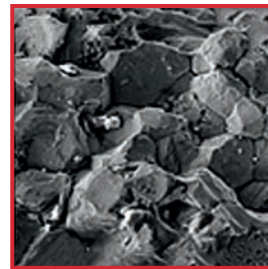
詳細：典型的な粒界割れした締め付け金具
