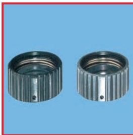
画像右：軟水化処理した水が、黒色陽極酸化処理していた器械表面を（白く）腐食
