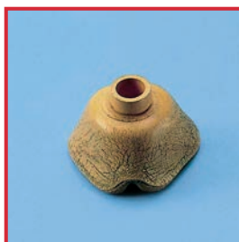
呼吸マスクの経年劣化によって生じた亀裂
