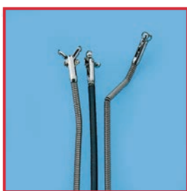
剪断力で破損した生検鉗子
