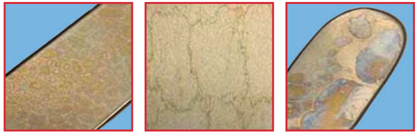
蒸気滅菌後にみられる、脱イオン水中の過剰な二酸化珪素によって引き起こされた、器具表面上の典型的な珪酸塩沈着物による変色
