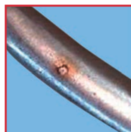
孔食を生じたピンセット原因：カラーコードバンドの経年劣化により塩化物を含む有害成分が浸透する。
