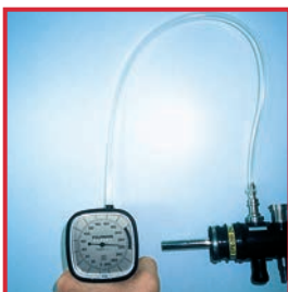
軟性内視鏡の手作業による漏水テスト
