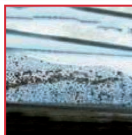
器械の表面のエッチング剤の部分的な効果と付着物。原因：接触時間が長かった。
