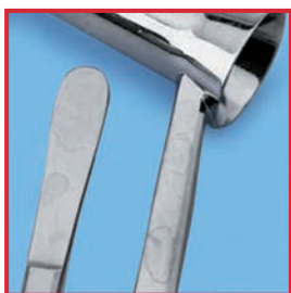
硬度の高い水を使用したすぎによって発生した汚れ
