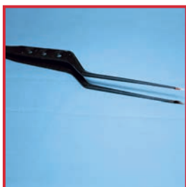
誤った取り扱いで生じた器械の変形
