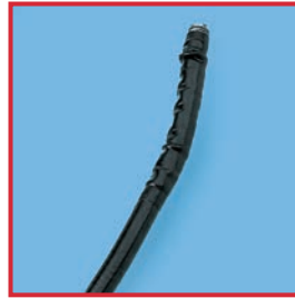
不適切な処理剤を用いたために発生した軟性内視鏡挿入部の膨潤
